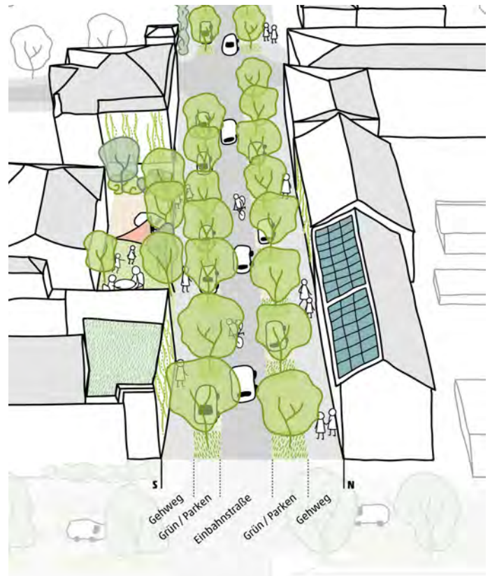
Abb. 82: Klimaaoptimierte Situation Straßenraum, Variante 3b
